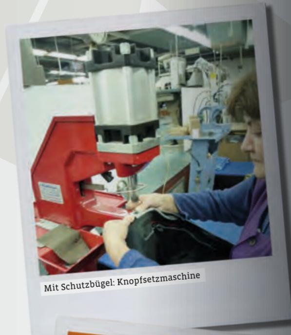
Mit Schutzbügel: Knopfsetzmaschine
